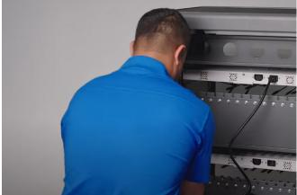
4: Répétez les étapes 1 à 3 pour le compartiment du bas. 5: Faites pivoter le chariot, puis ouvrez la porte arrière. Connectez les deux cordons d'alimentation aux concentrateurs, puis l'autre extrémité aux sorties auxiliaires de la barre d'alimentation avec minuterie.
