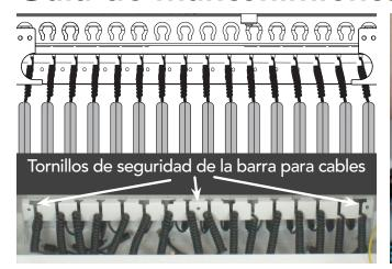
1: Los cables de carga de cada hub pueden estar fijados con tres tornillos de seguridad. Use la llave Torx T10 (C3) para quitar los tornillos que estén instalados. Al quitar la barra de seguridad, los cables de carga dejan de estar fijos y puede cambiarlos.
