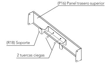
2: Para instalar el soporte de la envoltura del cable de alimentación, busque los dos pernos PEM que están en la parte posterior del panel trasero superior (P16) y quite las tuercas ciegas de los pernos con la llave de tubo (K11). Coloque el soporte (R18) en los pernos y después ajuste las dos tuercas ciegas de nuevo en los pernos para fijar el soporte en su lugar.
