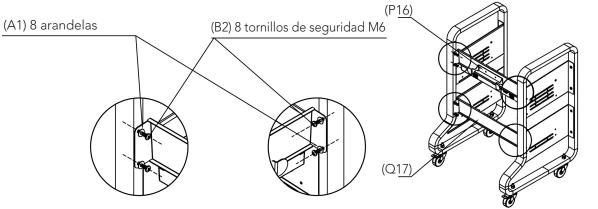
2: Para instalar el soporte de la envoltura del cable de alimentación, busque los dos pernos PEM que están en la parte posterior del panel trasero superior (P16) y dos arandelas (A1) a cada lado. Instale el panel trasero en el estante inferior (Q17) con dos tornillos de seguridad (B2) y dos arandelas (A1) de cada lado. No ajuste del todo los tornillos hasta después del paso 4.
