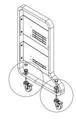
1: Activez le frein de chaque roulette (T20), si celles-ci ne sont pas déjà verrouillées. À l'aide de la clé fournie (J10), fixez 2 roulettes (T20) à chaque panneau latéral (L12), (M13) du chariot en utilisant 1 rondelle plate (F6), 1 rondelle à ressort (E5) et 1 écrou borgne (D4) sur chaque roulette.
