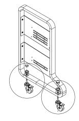
1: Si las ruedas (T20) no están ya bloqueadas, coloque el freno en cada una de ellas. Utilice la llave inglesa (J10) adjunta para fijar dos ruedas (T20) a cada lado del panel (L12), (M13) del carro con una arandela plana (F6), una arandela elástica (E5) y una tuerca ciega (D4) en cada rueda.
